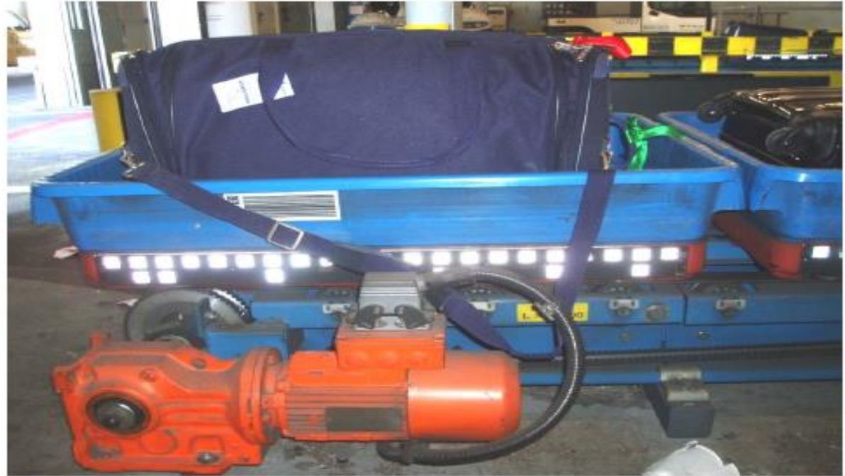
Verhakte Schlaufe in der Gepäckförderanlage
