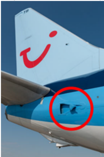
Boeing 737-800NG APU inlet door open
