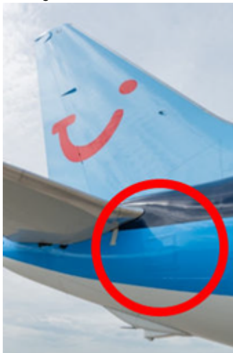
Boeing 737-8 APU inlet door open
