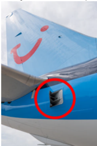
Boeing 737-8 APU inlet door open
